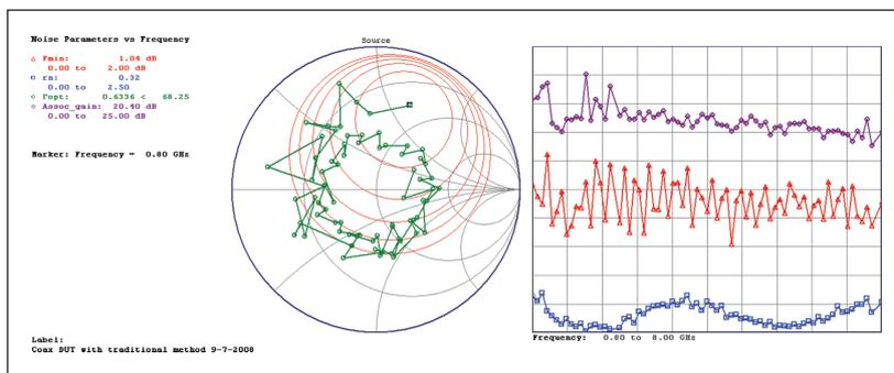
Измерения проводятся в ряде частотных точек во всей полосе частот с воспроизведением широкого диапазона значений импеданса источника в каждой частотной точке.
