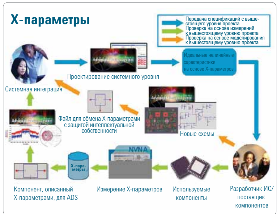
Рис. 1. Теперь X-параметры можно создавать на основе измерений или по результатам моделирования в САПР ADS, причем с той же скоростью и удобством, как и общеизвестные линейные S-параметры. Если X-параметры генерируются по моделям схемы в ADS, то результирующие нелинейные поведенческие модели можно с удобством использовать для ускорения разработки системного уровня.
