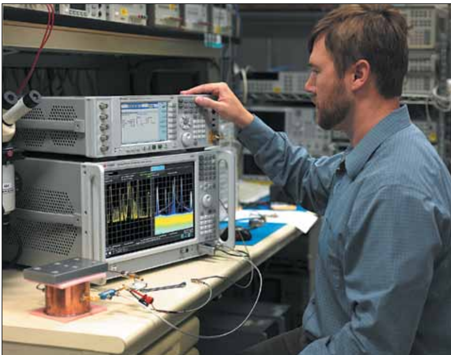
Рис. 1. Быстроперестраиваемый генератор сигналов Keysight UXG (сверху) является мощной основой для создания надежных гетеродинов и расширяемых имитаторов угроз
