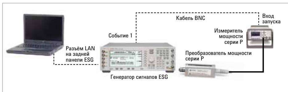
Рис. 11. Схема с измерителем мощности серии P и генератором сигналов ESG для измерения сигналов LTE с управлением по локальной сети.
