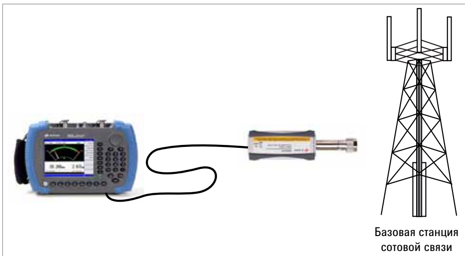
Рис. 4. Компактное решение для технического обслуживания базовой станции сотовой связи.
