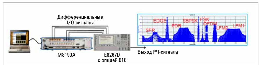
Рисунок 4 - Здесь показан сигнал нескольких источников излучения, включающий составляющие сигналов различных РЛС и систем связи, сгенерированный с использованием платформы для тестирования систем РЛС и РЭБ на базе САПР SystemVue компании Agilent.
