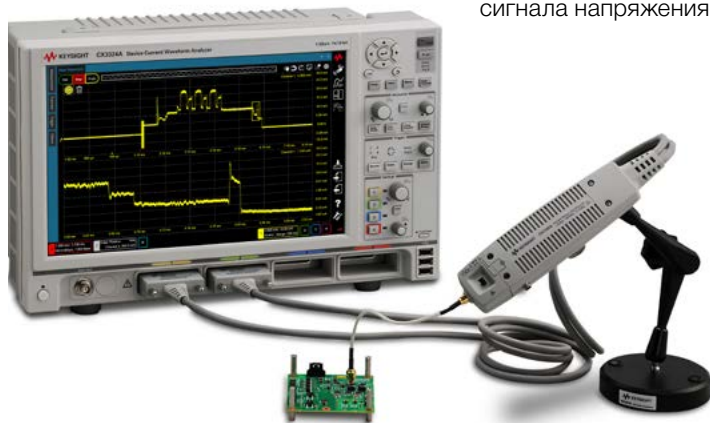
Анализатор CX3300A идеально подходит для измерений современных многофункциональных электронных блоков управления
