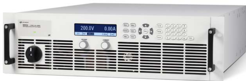
Серия N8900 — источники питания с автоматическим выбором диапазона, которые обеспечивают мощность от 5 до 150 кВт при напряжении до 1500 В и силе тока до 510 А
