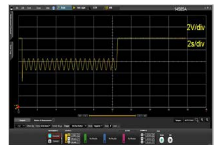
Пусковой профиль, созданный с помощью N6705C и ПО 14585A согласно стандарту ISO 16750-2: 4.6.3
