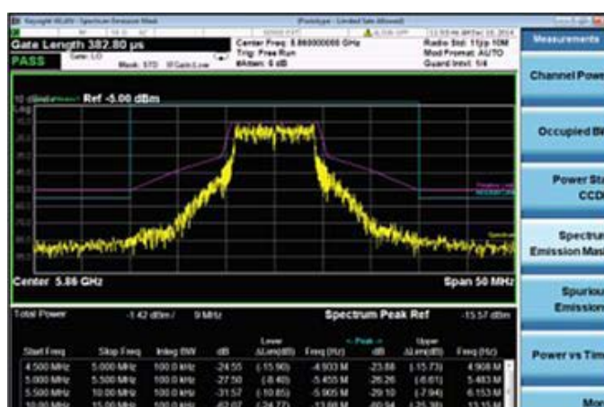
Измерение спектральной маски излучения (SEM) на передатчике 802.11p 10 МГц FCC класса А с максимальной выходной мощностью 0 дБм с помощью измерительного приложения WLAN N9077 компании Keysight
