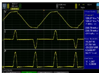
Измерение параметров с помощью PA2201A на сигнале, содержащем переменную и постоянную составляющие
