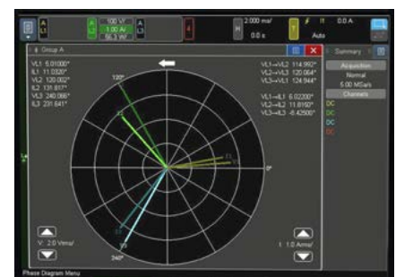
Измерение трехфазного сигнала с помощью PA2203A
