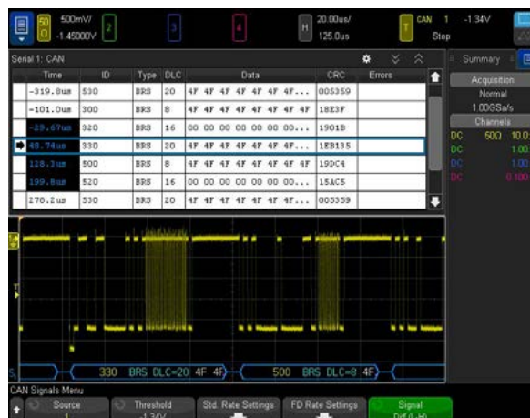
Запуск по символической последовательности и декодирование данных CAN/dbc
