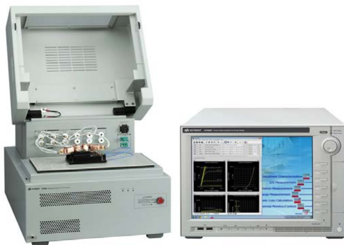
Анализатор B1506A для автоматизированного тестирования мощных полупроводниковых приборов
