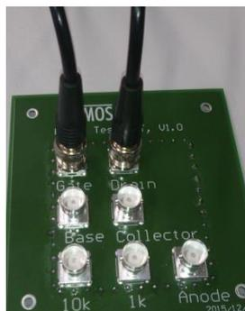
Фликкер шум измеряется как напряжение шума на выбранных измерительных резисторах и усиливается с помощью сверхмаломощного усилителя напряжения с переменным коэффициентом усиления.
