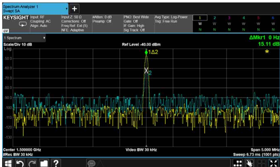
Рисунок 16. Поскольку анализатор сигналов учитывает при отображении уровня сигнала на экране ослабление входного аттенюатора и опорный уровень, наблюдаемая разница уровней второй гармоники вызвана наличием продуктов нелинейных искажений самого анализатора.
