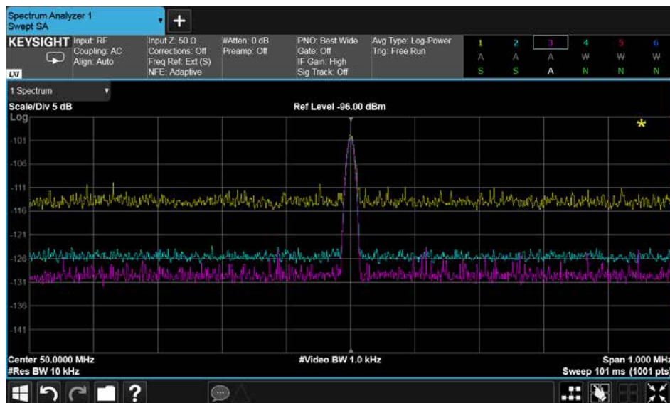
Рисунок 8. В ходе данных измерений средний отображаемый уровень шума постепенно снижается: сначала за счет уменьшения полосы разрешения (желтая кривая), затем в результате уменьшения ослабления входного аттенюатора (голубая кривая) и включения функции усреднения мощности по логарифмической шкале (розовая кривая).
