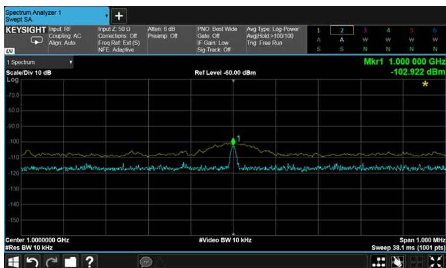
Рисунок 4. Уменьшение полосы разрешения со 100 кГц до 10 кГц улучшает показатель среднего отображаемого уровня шума, облегчая обнаружение и измерения параметров сигнала.
