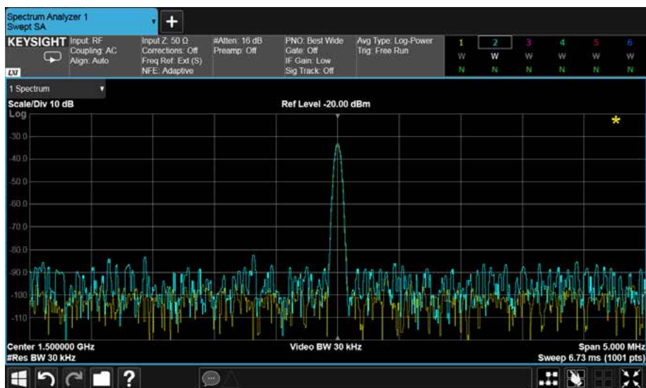
Рисунок 17. Признаком того, что собственные продукты нелинейных искажений анализатора не влияют на результат измерений, является равенство наблюдаемых уровней второй гармоники.
