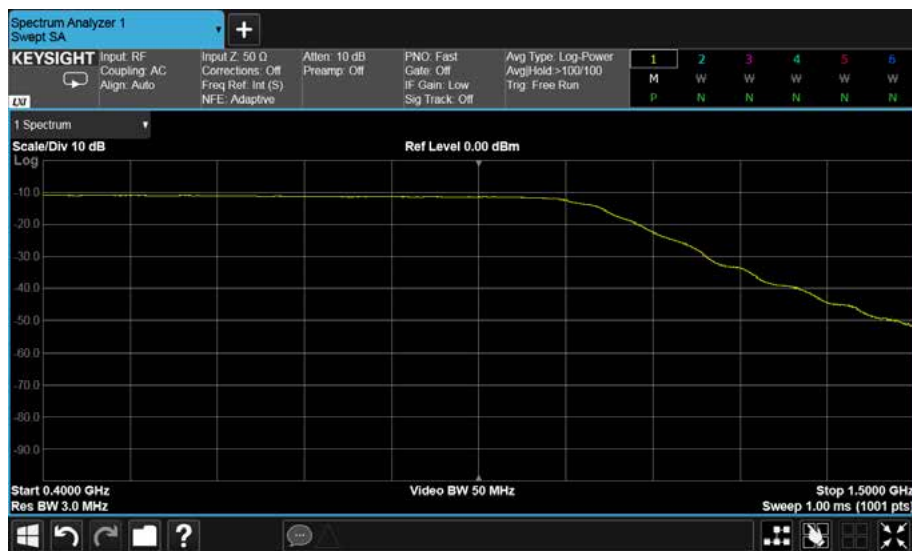
Рисунок 2. Данный график представляет собой АЧХ тракта передачи сигналов от ИУ к анализатору спектра.
