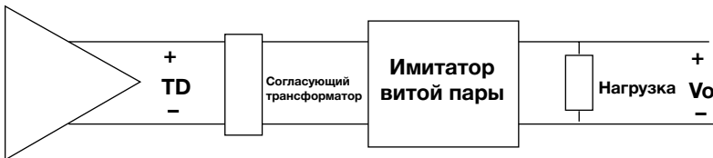
Рис. 2б. Цепь 10BASE-T TD подключена к нагрузке через модель витой пары (TPM).
