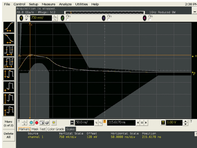
Рис.5. Сигнал LTP с TPM в шаблоне LTP.
