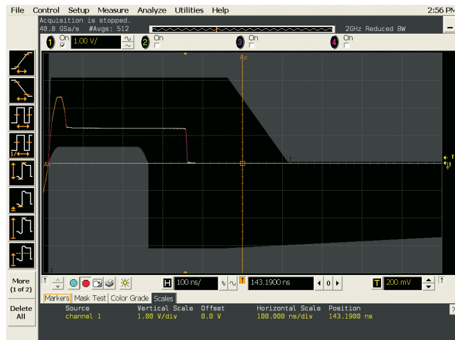
Рисунок 8. Сравнение сигнала TP_IDL с маской.
