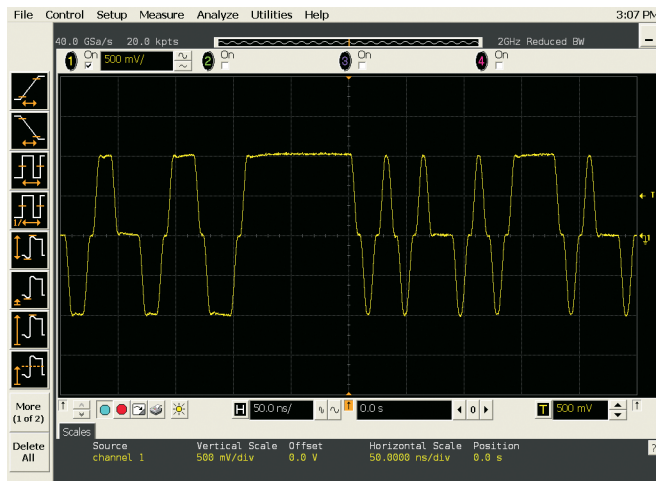
Рисунок 11. Пустая кодовая последовательность в формате кода MLT-3, поступающая от передатчика стандарта 100BASE-TX.
