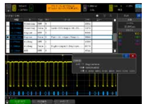
Пример запуска при обнаружении идентификатора сообщения CAN «Данные двигателя» Декодирование и запуск в реальном времени с использованием специальных аппаратных средств Выявление проблем путем сопоставления переданной информации с измеренными сигналами во времени
