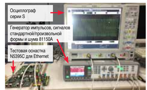
Испытания передатчика BroadR Reach Пример конфигурации измерительной системы
