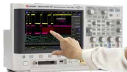
Пример запуска при обнаружении идентификатора сообщения CAN «Данные двигателя» Декодирование и запуск в реальном времени с использованием специальных аппаратных средств Выявление проблем путем сопоставления переданной информации с измеренными сигналами во времени
