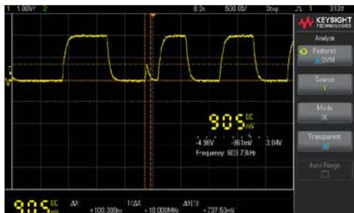
Цифровой вольтметр точно измеряет действующее значение напряжения в диапазоне от 20 Гц до 100 кГц.
