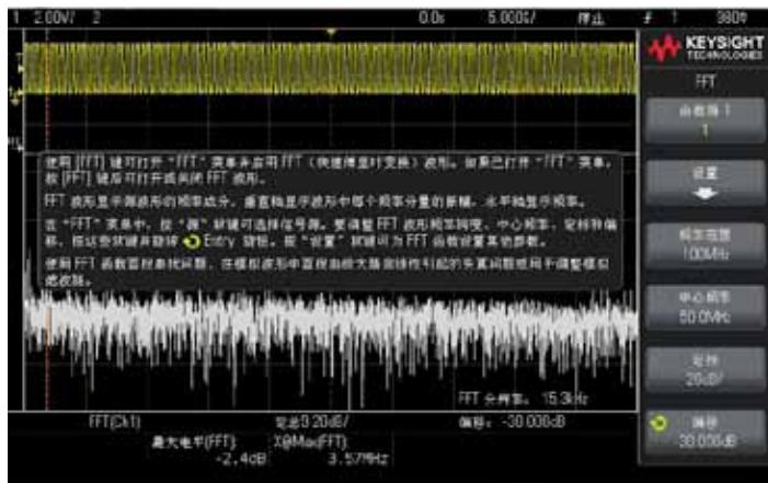
Пример дисплея БПФ с интерфейсом и встроенной справкой на китайском языке.
