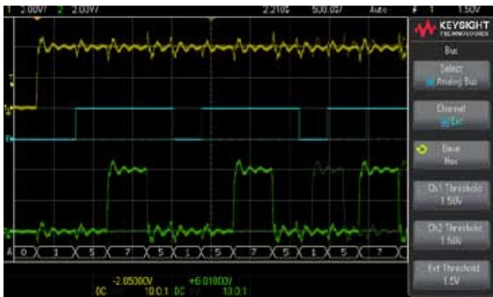
Каналы 1, 2 и вход внешнего запуска можно объединить в одну шину, значения которой могут отображаться в нижней части экрана в шестнадцатеричном или двоичном формате.
