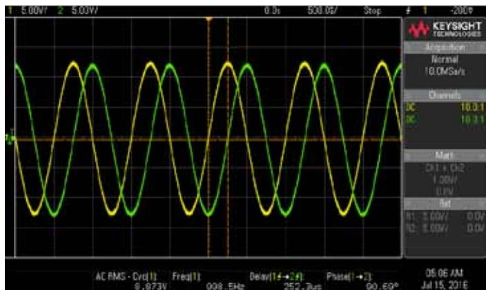
На экран осциллографа можно вывести до четырёх отдельных измерений.
