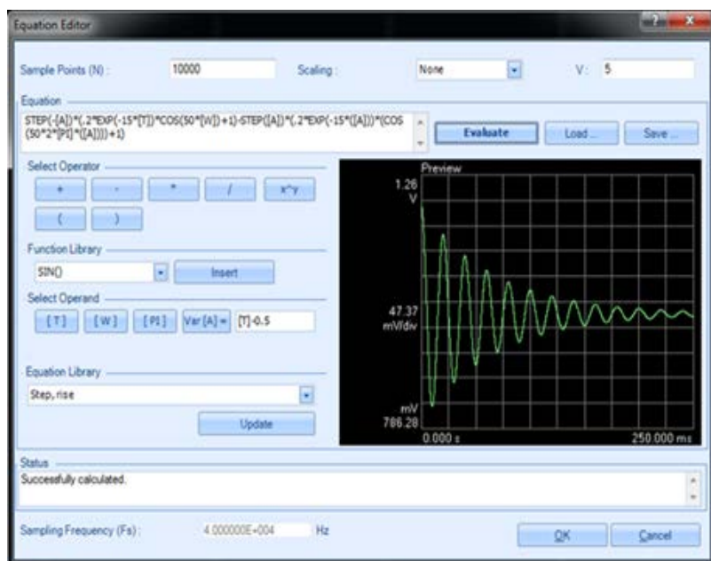
Рис. 7. Редактор функций в приложении Waveform Builder
