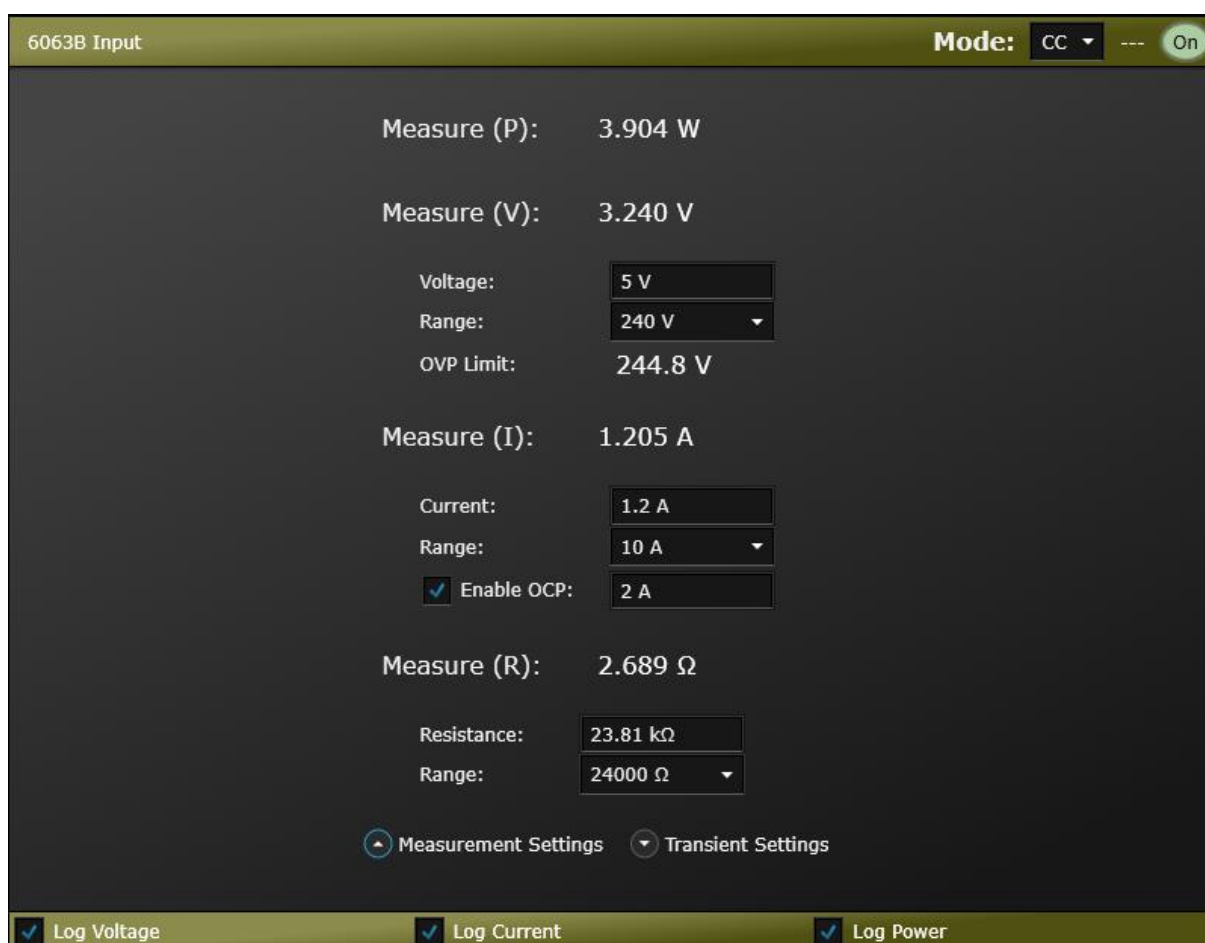
Рис. 6. Настройка приложения для управления электронными нагрузками и автоматизации измерений ПО BenchVue
