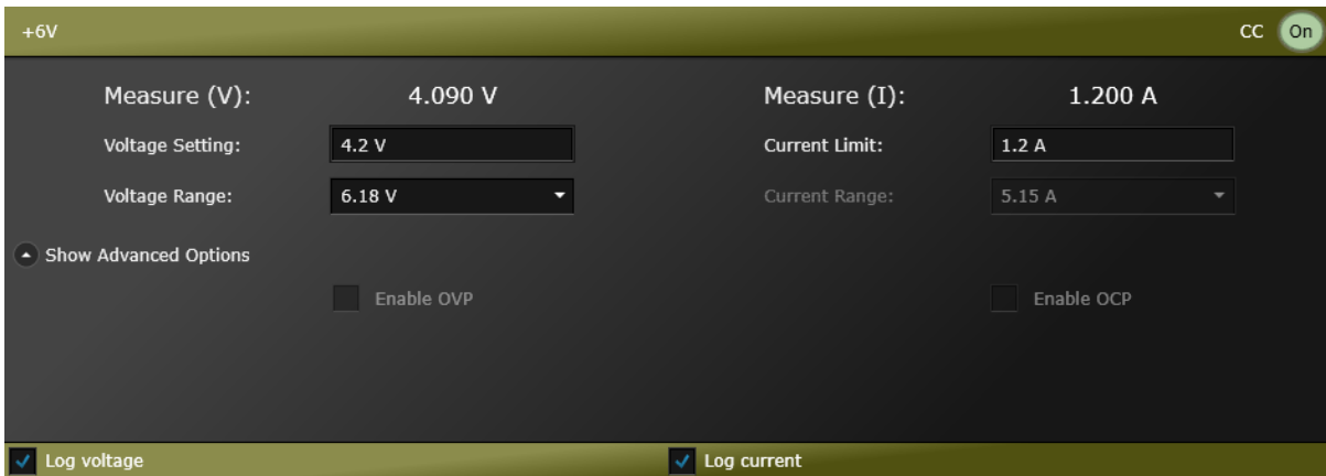
Рис. 4. Настройка каналов в приложении для управления источниками питания и автоматизации измерений ПО BenchVue
