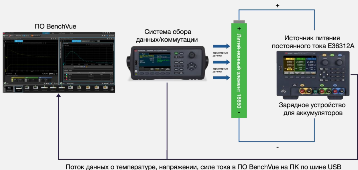
Рис. 1. Построение температурного профиля литий-ионного аккумулятора при зарядке с помощью системы сбора данных/коммутации Keysight DAQ970A, источника питания постоянного тока E36312A и ПО BenchVue
