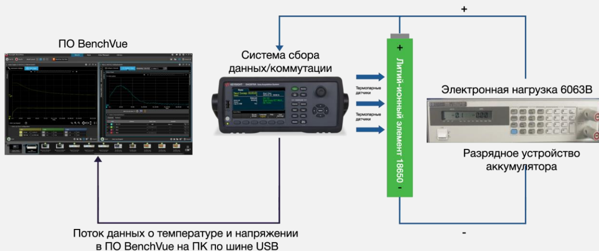
Рис. 5. Построение температурного профиля при разрядке аккумулятора с помощью системы сбора данных Keysight DAQ970A, электронной нагрузки постоянного тока 6063 В и ПО BenchVue
