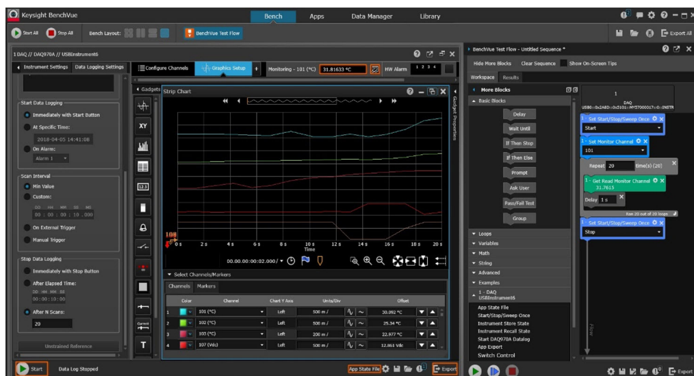
Рис. 7. Пример ПО BenchVue DAQ компании Keysight, запускаемого на ПК и предназначенного для настройки конфигурации, визуализации данных и экспорта результатов
