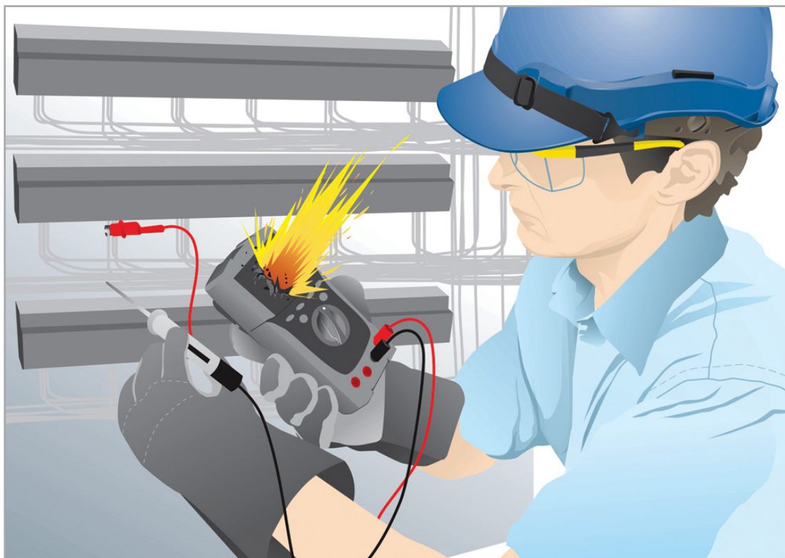
Рисунок 4. Иллюстрация возможной вспышки дуги
