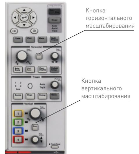
Рис. 18. Легкодоступные кнопки масштабирования по горизонтальной и вертикальной осям
