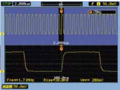
В режиме True Zoom можно просматривать длинные записи и одновременно открывать подробное отображение сигнала в окне масштабирования.
