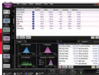
Расширенный анализ амплитуды и джиттера. Точное выделение джиттера и амплитудных искажений позволяет получить согласованное значение полного джиттера (TJ) и определить причину закрытия глазка.
