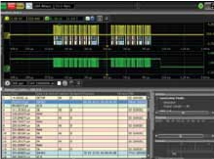
Запуск по сигналам и декодирование данных последовательной шины USB позволяет получить коррелированные по времени представления сигналов и символов на уровне битов, что упрощает обнаружение программных или аппаратных сбоев.
