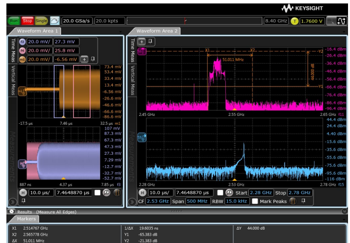
Выполните измерения в интересующей области с помощью оконной функции.
