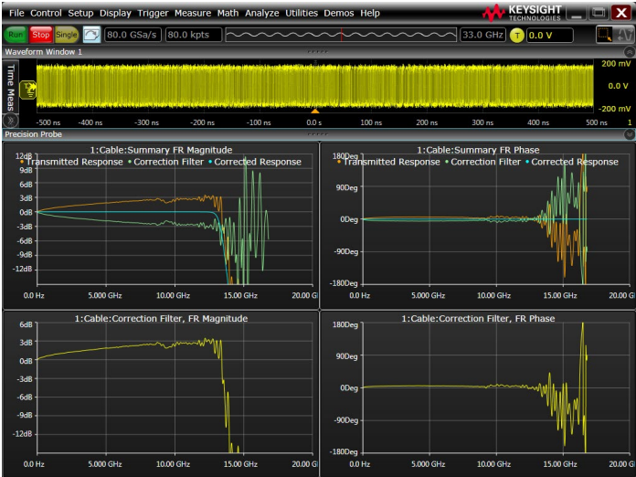
АЧХ и ФЧХ кабеля, скорректированные с помощью технологии PrecisionProbe.
