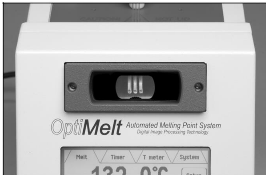
Рисунок 2. OptiMelt предлагает возможность автоматического определения температуры плавления при одновременной визуализации образцов.
