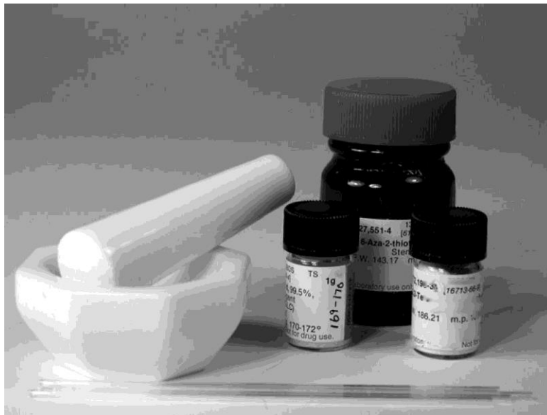
Твердые вещества, ступка, пестик и капилляры - основные ингредиенты для приготовления образца.
