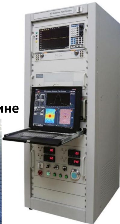
Подвижная наружная система тестирования антенн в дальней зоне
