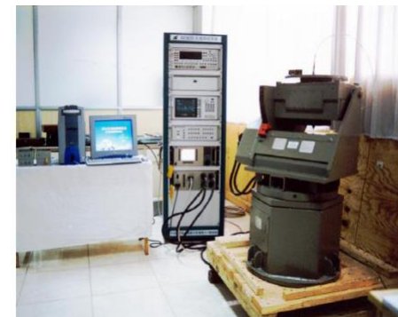
Подвижная наружная система тестирования антенн в дальней зоне
