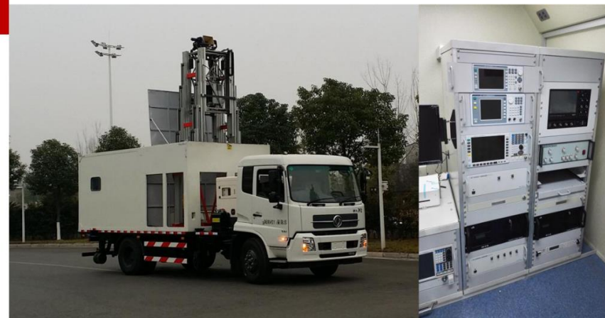
Подвижная наружная система тестирования антенн в дальней зоне
