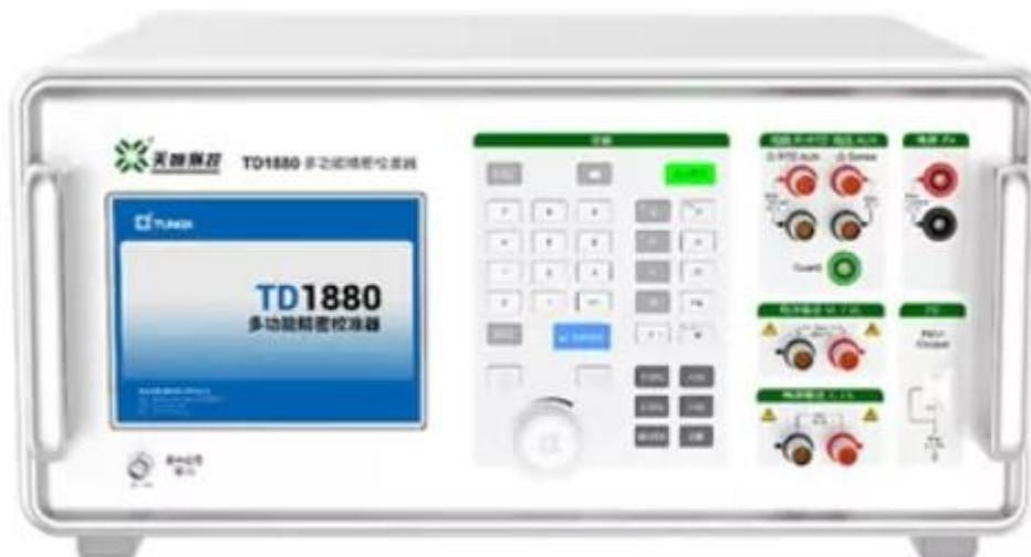
TD1880, широкодиапазонный, многофункциональный и высокоточный калибратор, может выдавать сверхточное напряжение переменного/постоянного тока, ток, регулировать фазу и мощность, а также имеет функции импульсного выхода и моделирования сопротивления постоянному току, термодпары (ТП), термического сопротивления (RTD) и емкости. Применяется для калибровки мультиметров с разрядностью  $6^{1/2}$  и ниже или других электроизмерительных приборов.
