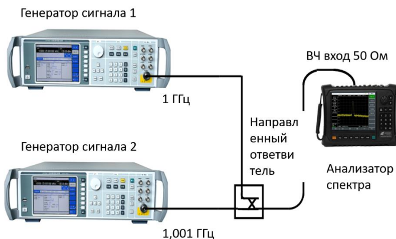
Рис.1 Подключение системы измерения ИМ искажений третьего порядка
