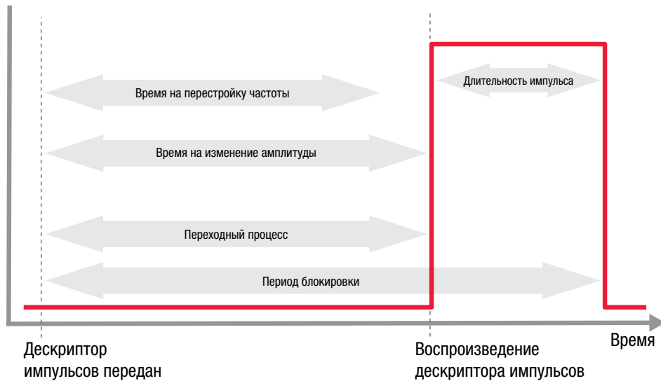
Рисунок 4. Возможность имитации нескольких источников ЭМИ зависит не только от параметров этих источников (например, частоты повторения импульсов и длительности импульса), но и от скорости переключения и времени стабилизации частоты и амплитуды сигнала, которые определяются используемым генератором сигналов. Если генератор находится в процессе перестройки, он не может воспроизводить импульс. Если же воспроизводится заданный импульс эмиттера, то блокируется переключение. Генератор не в состоянии имитировать различные цели в период блокировки (время от подачи до завершения выполнения управляющей команды).
