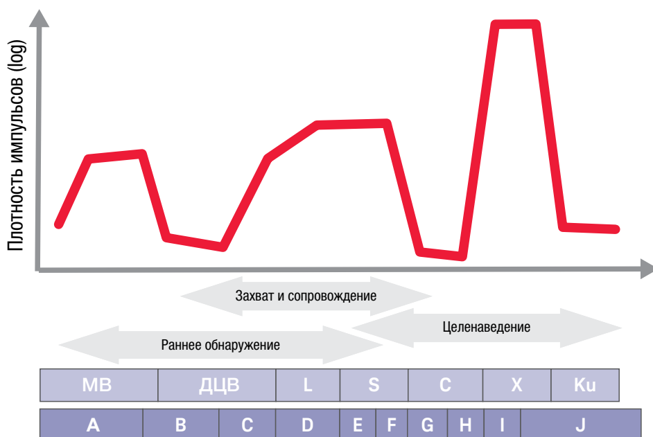
Рисунок 1. Общая картина распределения и плотности целей РЭБ по частотным диапазонам в обычной оперативной обстановке. Реальная сигнально-помеховая обстановка в ВЧ- и СВЧ-диапазонах сочетает в себе ряд источников ЭМИ, соответствующих образцам вооружения и военной техники (ВВТ), а также гражданского и коммерческого назначения.
