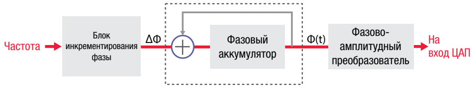
Рисунок 9. Функциональная блок-схема генератора с цифровым управлением.
