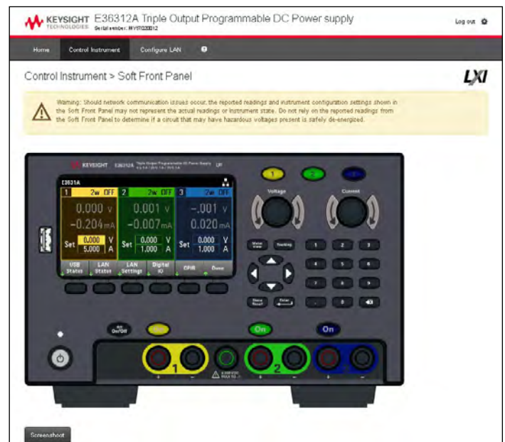
Рис. 6. Управление источником питания при помощи удобного графического интерфейса пользователя, имитирующего лицевую панель прибора.
