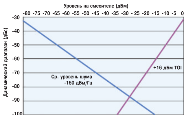
Выдающиеся характеристики по интермодуляционным искажениям третьего порядка обеспечивают максимальный динамический диапазон
